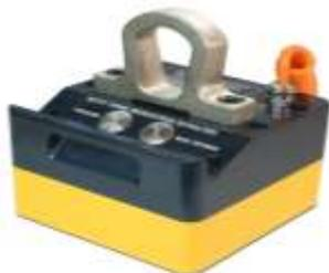
Elevador electro permanente mod. EPM-BA 1000 con una capacidad de elevación máxima de 1000 kg a partir de un espesor de 25 mm , y una zona de contacto de 170x170 mm.
